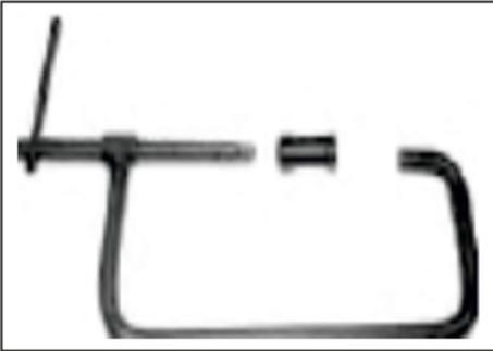
**Compresor de resorte de válvulas y adaptador**
