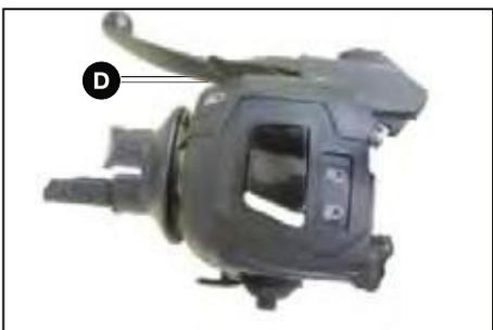
**Interruptor de pase :** Pulse el interruptor a parpadear la luz la principal. Se utiliza para dar señales a los vehículos que vienen de otro lado, mientras adelantamos
