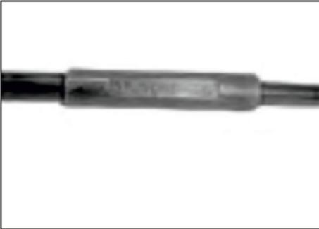
**Conductor del pin del pistón**
