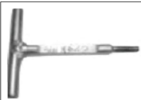
**Extractor del eje de balancines**
