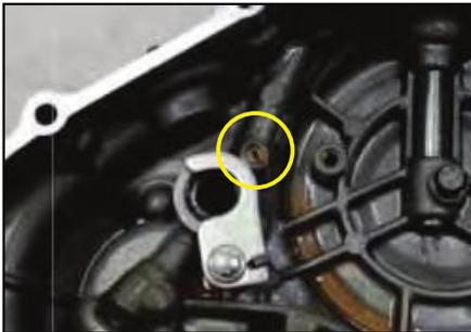
**LIMPIEZA INYECTOR CUBIERTA DEL CLUTCH**
