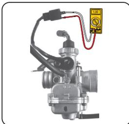
Chequeo de voltaje en condición parcialmente abierto:
