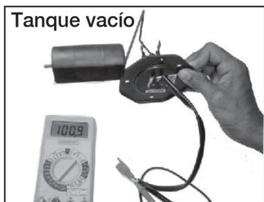
**Medidor del tanque**
