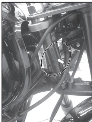
La serie de chasis está ubicada en la parte derecha del canuto, con un serial alfa-numérico de 17 dígitos.
