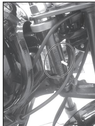
Las series de identificación del motor y chasis usados para el registro de la motocicleta, son dígitos únicos alfa-numéricos para identificar cada modelo en particular.
