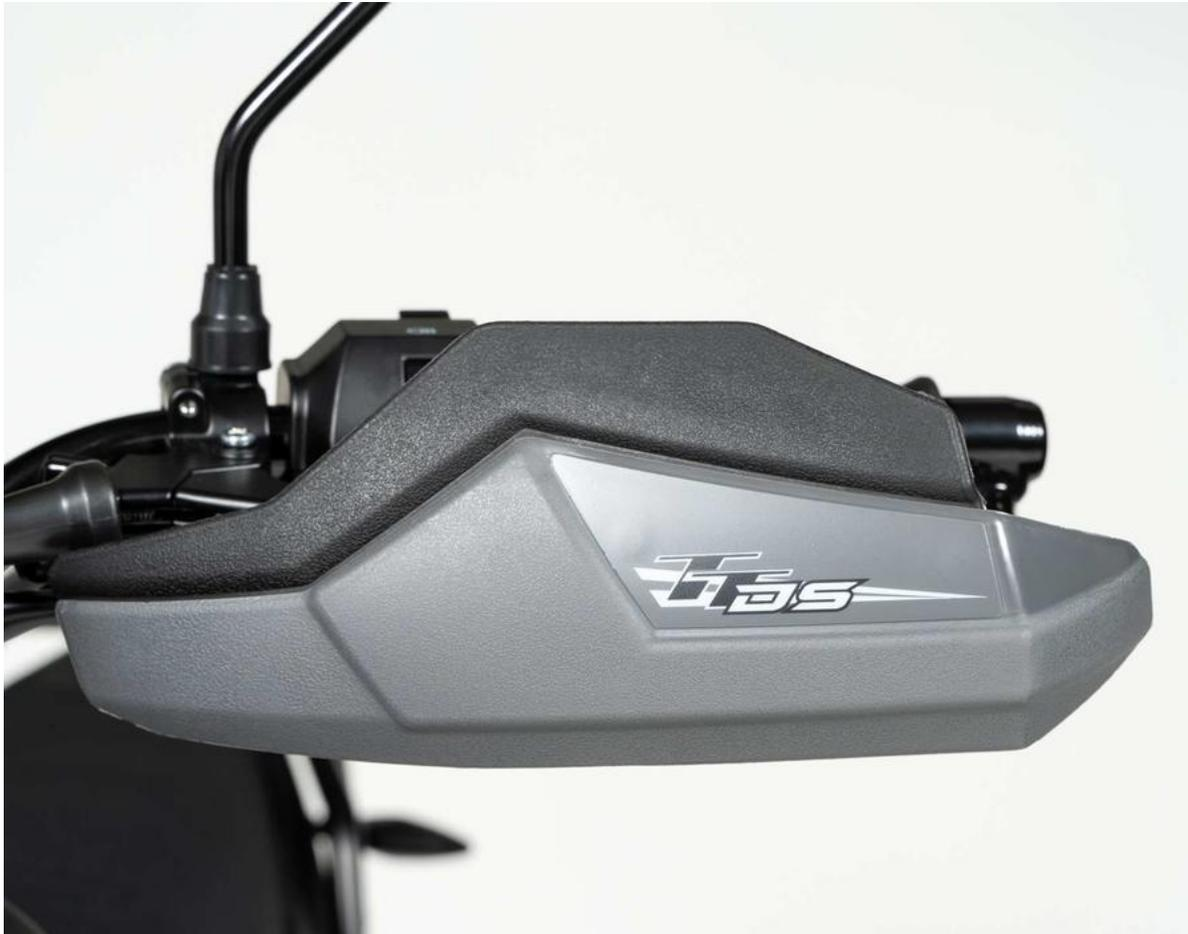
Protegen del frío o el viento y ayudan a minimizar daños o lesiones en las manos del conductor en las caídas.
