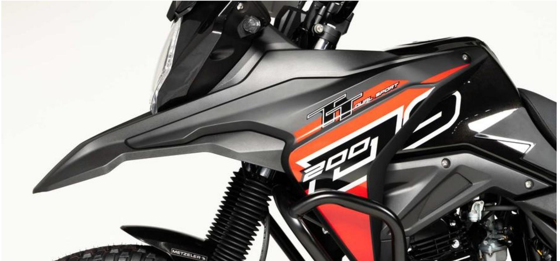
Diseño agresivo típico de motocicletas de Rally. Este nuevo diseño proporcionara mayor comfort para largos viajes, además de oponer la menor resistencia al viento. Sus carenajes están fabricados en polipropileno, proporcionando una mayor resistencia a los impactos.
