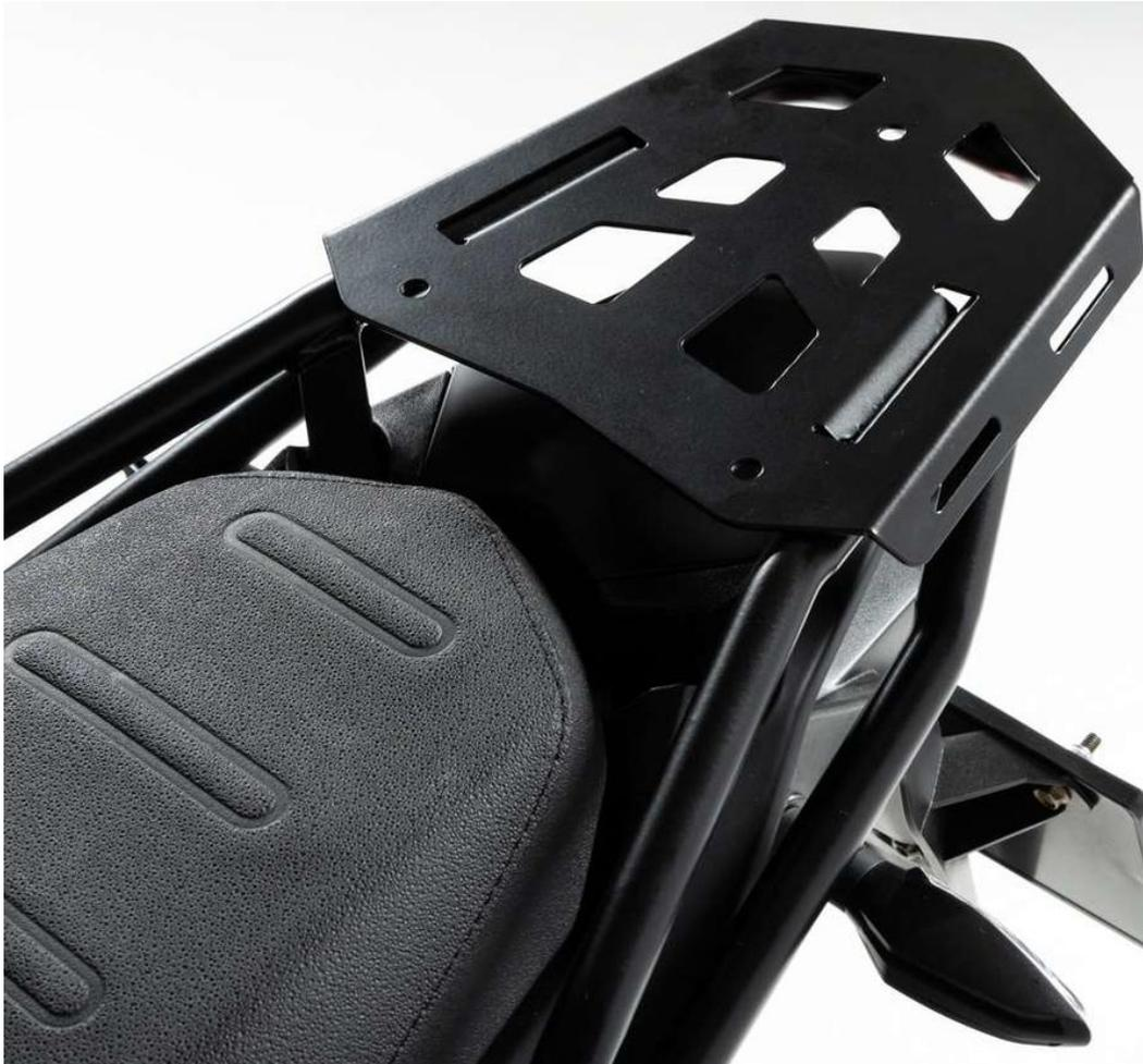
Ideal para sujetar peso de hasta de 5 kg o llevar un maletero que amplíe la capacidad de carga de tu moto.
