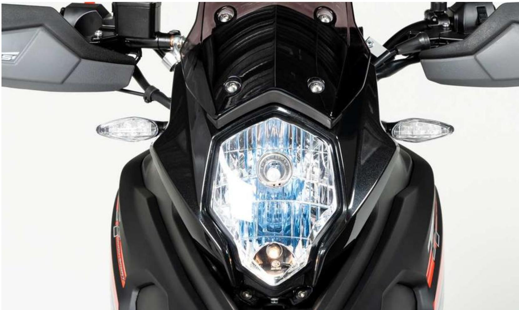
Farola multifocal con un diseño agresivo tipo Rally. Direccionales LED con mejor iluminación, menor consumo de energía y mayor durabilidad.
