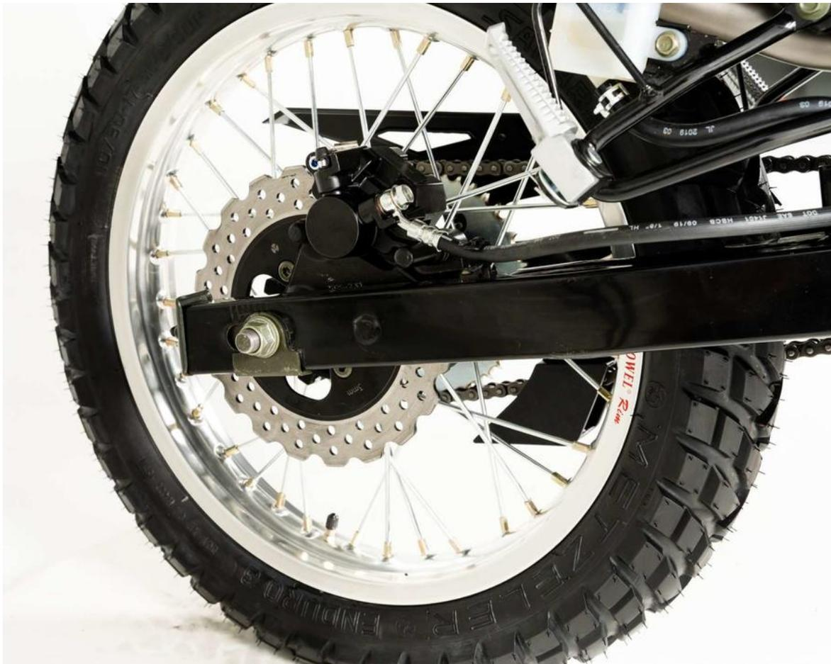
Otorgan una mayor resistencia a los impactos, además de un menor peso. Este tipo de rines normalmente son utilizados en motocicletas de alta cilindrada.
